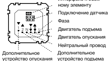
Механизм управления жалюзи с дополнительным входом (артикул MTN580699)
