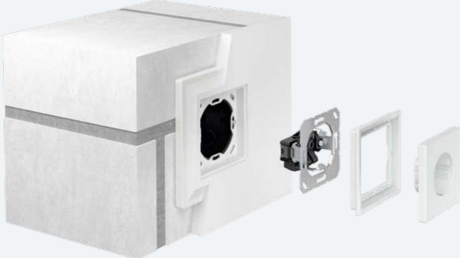
Для установки изделий серии LS Zero используется обычная установочная коробка и особая узкая рамка. Добраться единого уровня со стеной помогает специальный монтажный адаптер (рамка), который за счёт своего материала плотно фиксируется штукатуркой, что позволяет избежать появления трещин в дальнейшем. В комплекте поставки также идёт вспомогательный элемент для монтажа.
