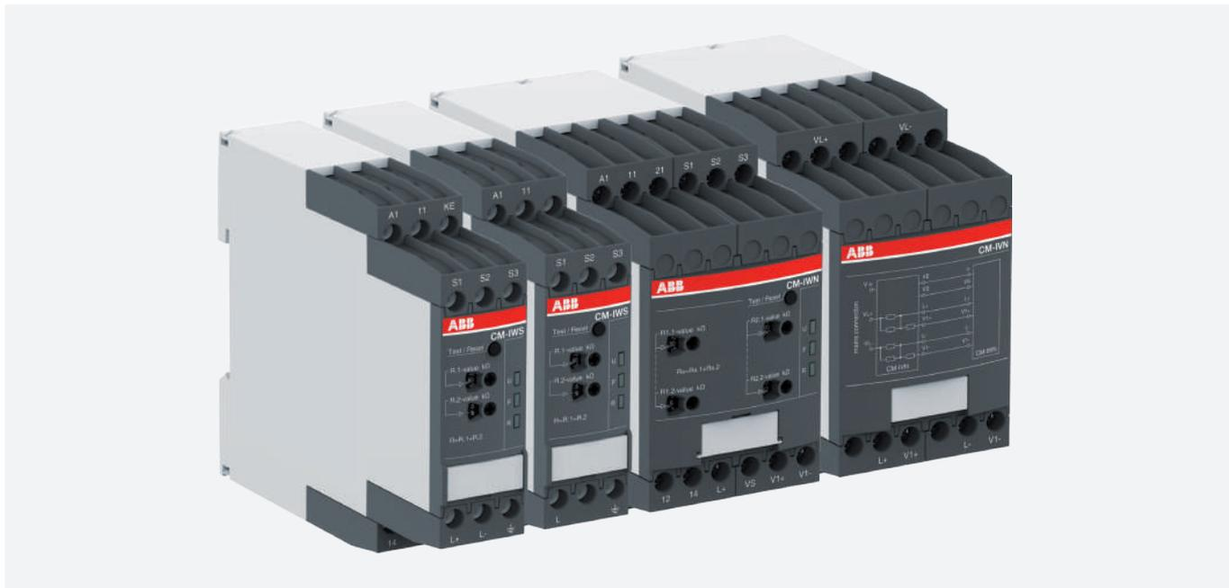
Реле контроля изоляции серии CM-IWx применяются для непрерывного контроля изоляции сетей с изолированной нейтралью и сигнализации режимов, при которых контролируемое значение сопротивления падает ниже установленного минимального порога срабатывания. Это обеспечивает надежную работу системы и предотвращает внеплановый останов оборудования, вызванный вторым пробоем изоляции, который может привести к короткому замыканию и срабатыванию силового автоматического выключателя.
