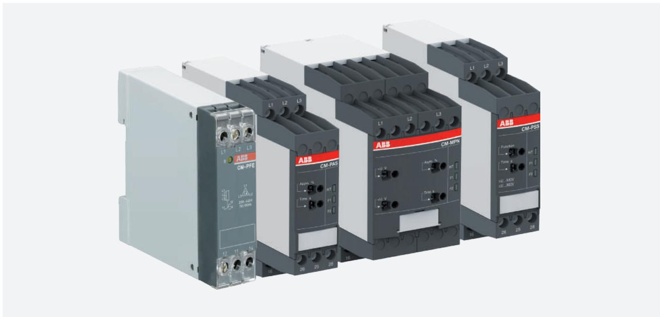
Реле контроля серии CM представлены широким ассортиментом высокотехнологичных компактных реле, осуществляющих контроль параметров трехфазного напряжения в сетях электроснабжения. Реле контроля напряжения серии CM позволяют контролировать чередование фаз, обрыв фазы, асимметрию фаз, а также просадку и превышение напряжения в пределах от 160 до 820 В.
