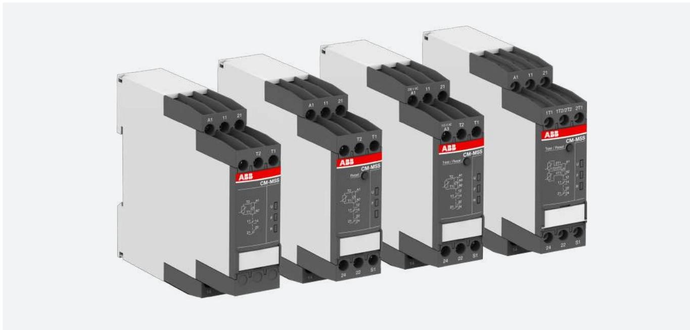
Реле термисторной защиты электродвигателя серии CM-MSx применяются для защиты от перегрева электродвигателей с помощью датчиков с положительным температурным коэффициентом сопротивления (ПТС).
