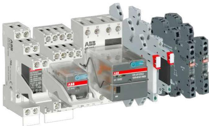
Большое количество серий интерфейсных реле и оптопар компании ABB обеспечивает гибкие возможности выбора. Наиболее востребованные продукты данной группы — втычные реле, обеспечивающие простую замену устройств, и оптопары с повышенной устойчивостью к электрическому износу. В основе электромеханических реле лежит магнитопровод с катушкой управления, тогда как оптопары имеют в своей конструкции твердотельные электронные ключи.
