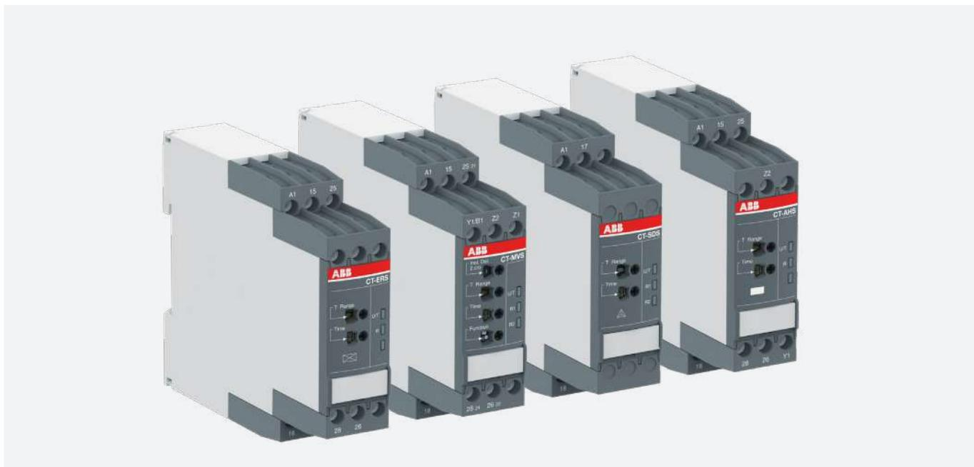
Продвинутая серия реле времени CT-S представлена 22 однофункциональными и 16 многофункциональными (до 13 функций) реле времени. В устройствах предусмотрено семь или десять диапазонов времени от 0,05 секунды до 300 часов. Установка устройств на DIN-рейку не требует использования инструментов, что обеспечивает простой монтаж и демонтаж оборудования.
