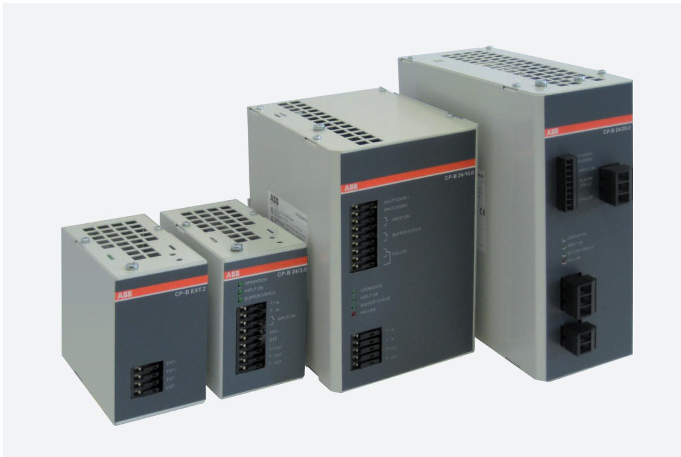
Буферные модули CP-B на базе ультраконденсаторов предназначены для буферизации нагрузки при нарушении электроснабжения и на короткий срок обеспечивают бесперебойное питание потребителей 24 В постоянного тока.
